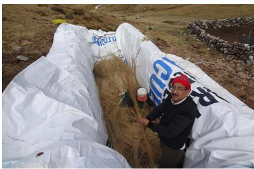
**INFLANDO EL REACTOR PARA PROBAR POSIBLES FUGAS**
